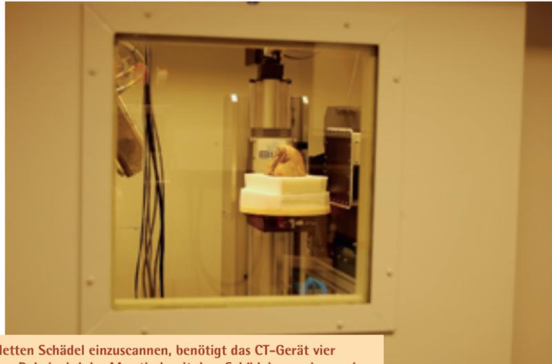
Um einen kompletten Schädel einzuscannen, benötigt das CT-Gerät vier bis sechs Stunden. Dabei wird der Messtisch mit dem Schädel um seine senkrechte Achse gedreht, sodass der Scanner das Objekt rundherum erfassen kann. Der Computer rechnet diese Aufnahmen zu einem Graustufenbild um.
