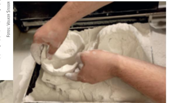
Mithilfe eines 3-D-Druckers wird die Computerrekonstruktion in ein Gipsmodell überführt. Der Drucker arbeitet wie ein gewöhnlicher Tintenstrahldrucker – nur eben in drei statt in zwei Dimensionen. Anschließend wird der Schädel aus dem Gipsbett herausgenommen und mit einem Pinsel gesäubert.
